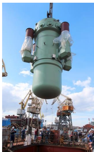
Рисунок 2. Погрузка РУ РИТМ-200 для головного атомного ледокола «Арктика» Figure 2. Loading the RITM-200 reactor plant for the lead nuclear-powered icebreaker «Arktika»
