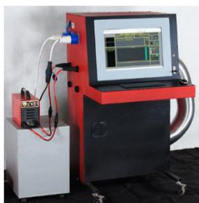
Рисунок 1. Сварочный регистратор ИНЭМ-ЭКСПЕРТ
