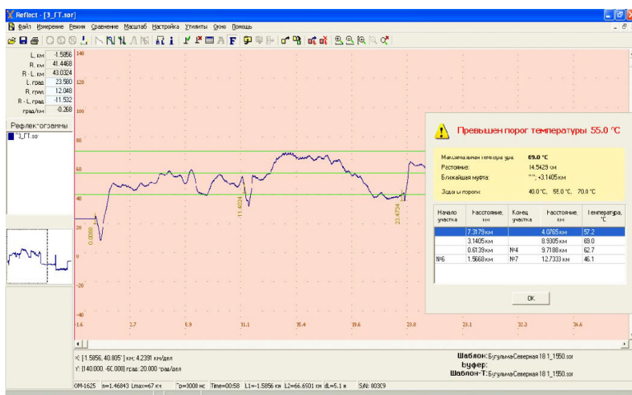
Рисунок 5 – Термограмма плавки гололеда переменным током. ВЛ 110 кВ Зимовники-Ремонтное [Thermogram of ice melting by alternating current. VL 110 kV Zimovniki-Remontnoye]
