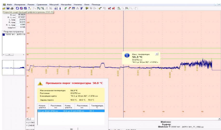
Рисунок 4 – Термограмма плавки гололеда постоянным током. ВЛ 220 кВ РП 220кВ Волгодонск-Зимовники [Thermogram of smelting ice with direct current. VL 220 kV RP 220kV Volgodonk-Zimovniki]
