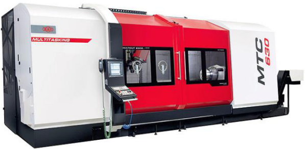
Рисунок 5. Токарно-фрезерный центр с ЧПУ MULTICUT 630/2000S Figure 5. CNC turning and milling center MULTICUT 630/2000S
