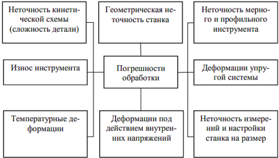
Рисунок 3. Причины погрешностей в СПИД токарной обработки 3 Figure 3. Causes of errors in the turning process 3
