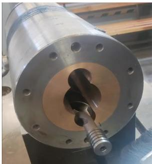
*Рисунок 3. Корпус НГПР с запрессованной втулкой из бронзы*
