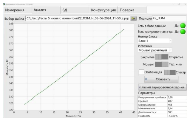
Рисунок 5. Тарировочная характеристика привода при закрытии ЭПА
