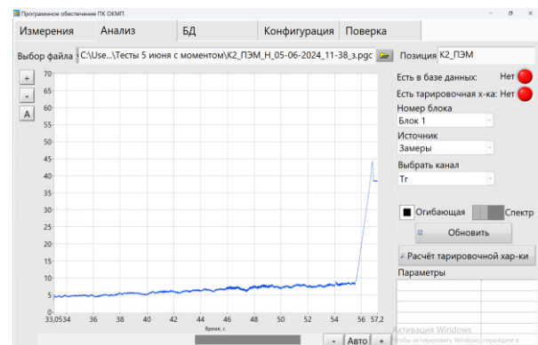
Рисунок 4. Измеренный момент при закрытии ЭПА Figure 4. Measured torque at closing of the motor operated valve
