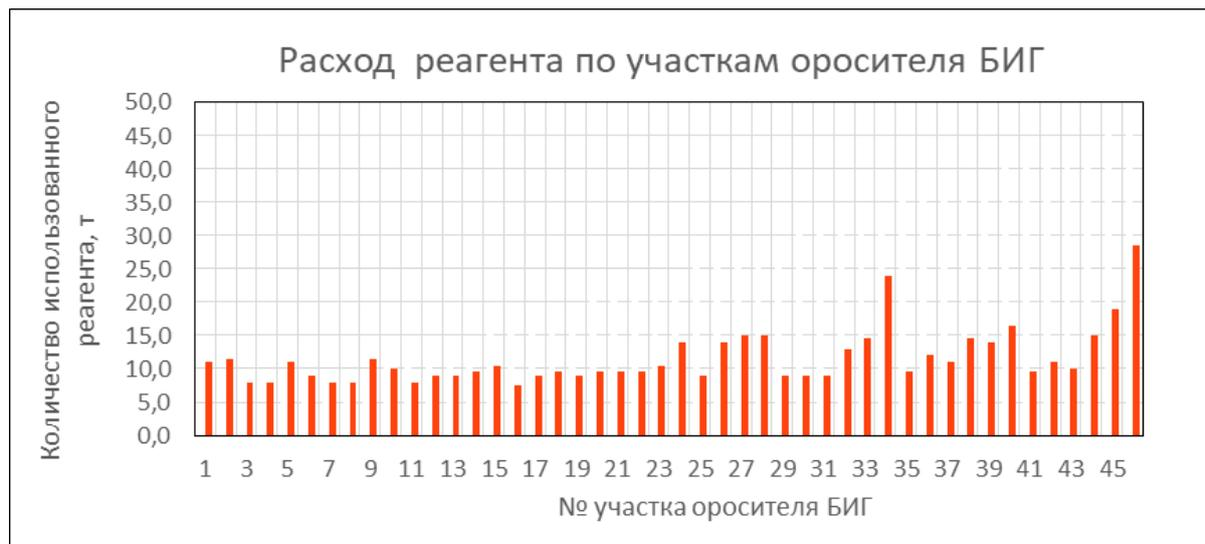
**Рисунок 7.** Расход реагента для очистки центральной зоны оросителя
