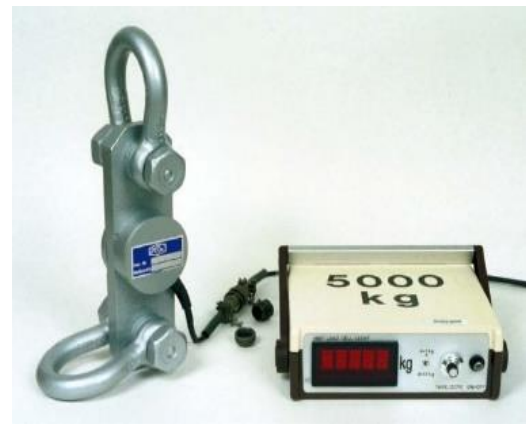
Рисунок 11. Система взвешивания на основе тензодатчиков, LCBS [12]
