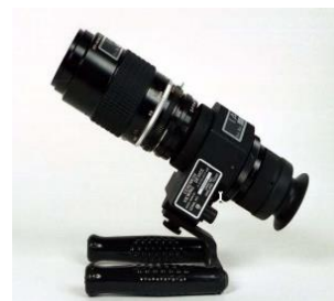
Рисунок 7. Усовершенствованный прибор для анализа свечения Черенкова, ICVD [12]
