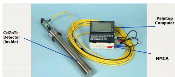
Рисунок 5. Тестер характеристик облученного топлива, IRAT. Мини-многоканальный анализатор, MMCA [12]
