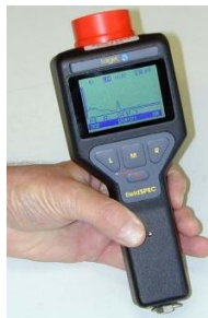
Рисунок 3. Ручной зонд для анализа гамма излучения, НМ-5 [12]
