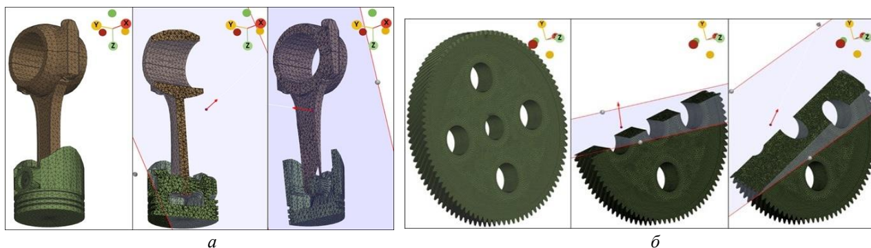
Рисунок 6. Скрытие полупространства: a – первой сеточной модели; б – второй сеточной модели Figure 6. Half-space hiding: a – the first mesh model; б – the second mesh model
