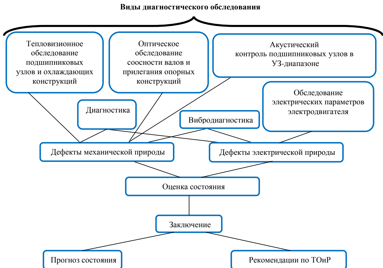
Рисунок 2 – Схема комплексной диагностики [Integrated diagnostics scheme]
