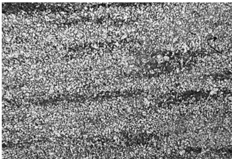
Рисунок 1 – Ликвационная неоднородность поковок из стали 10ГН2МФА (более темные участки содержат больше углерода и сильнее легированы), \times 100 [Liquidation heterogeneity of forgings from 10GN2MFA steel (darker sections contain more carbon and are more alloyed), \times 100 ]
