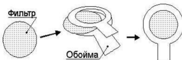
Рис. 4. – Общий вид САИ на основе фильтра АФА-РСП-20 [General view of special aerosol sources based on the AFA-RSP-20 filter]
