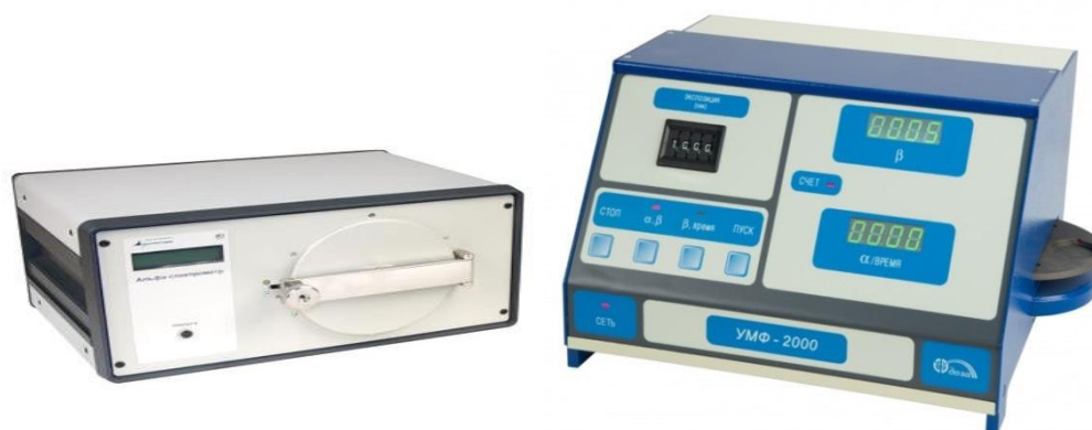
Рис. 3. – Установки MKS-01A (слева) и УМФ-2000 (справа) [Installations MKS-01A (left) AND UMF-2000 (right)]
