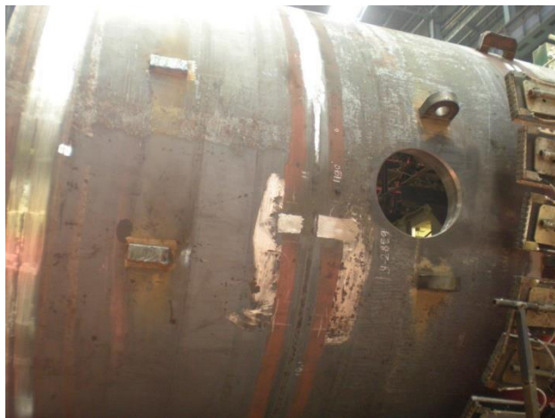
Рисунок 2. Обечайка с отверстием под установку патрубка
