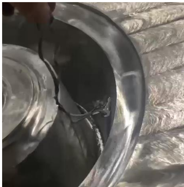
Рисунок 3. Намагниченность при сборке под сварку обечайки нижней с большим патрубком
