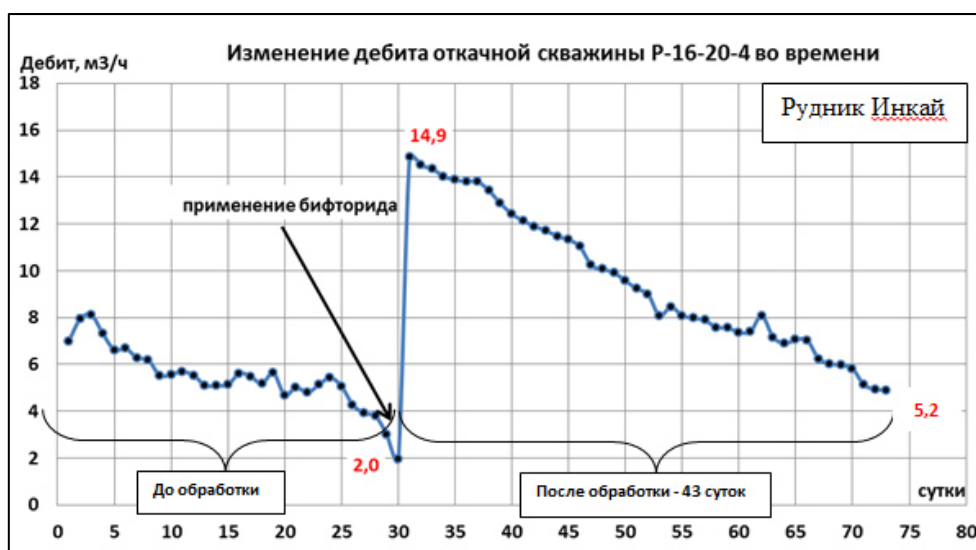
Рисунок 1. Динамика дебита технологической скважины до и после химической декольматации на руднике «Инкай»
