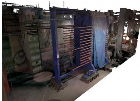
Рисунок 6. Трехмерное изображение оборудования, полученное из облака точек
