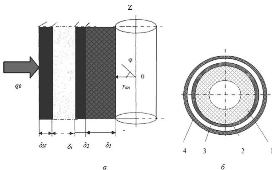
Рисунок 2 – Расчетная схема: *a* – общая схема для разработки математической модели; *б* – четырехслойная конструкция; 1 – ТРТ; 2 – капрон; 3 – резина; 4 – материал типа KEVLAR [Design scheme: *a* – general scheme for developing a mathematical model; *b* – four-layer construction; 1 – solid propellants; 2 – nylon; 3 – rubber; 4 – Kevlar material]
