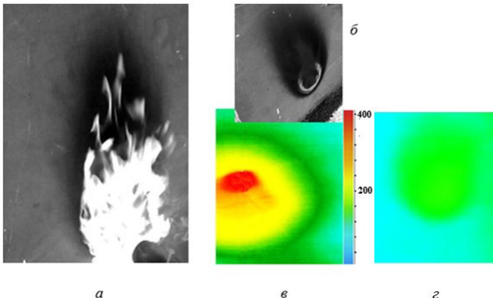
Рисунок 5 – Проведение эксперимента: *a* – воздействие открытого пламени на образец; *b* – образец после воздействия; *c* – изображение внешней поверхности на тепловизоре через 5 секунд после прекращения нагрева; *d* – внутренняя поверхность на тепловизоре через 5 секунд после прекращения нагрева
