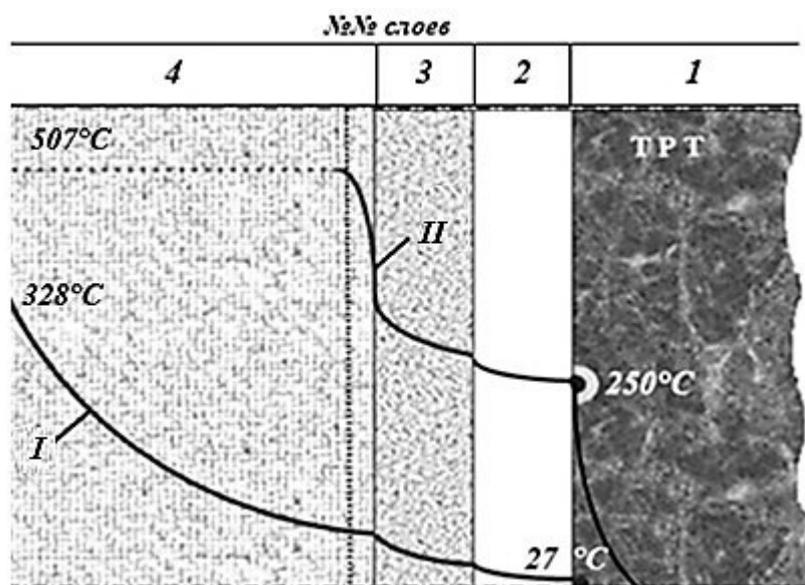
Рисунок 3 – Результаты расчета для  $q = 20 \text{ кВт/м}^2$ : I – температурное поле в момент начала нагрева ТРТ ( $\tau = 125$  секунд); II – температурное поле в момент воспламенения ТРТ ( $\tau = 471$  секунда) [The results of the calculation for the  $q = 20 \text{ kW/m}^2$ : I – temperature field at the moment when solid rocket fuel starts heating ( $\tau = 125$  seconds); II – temperature field at the moment when solid rocket fuel ignites ( $\tau = 471$  seconds)]
