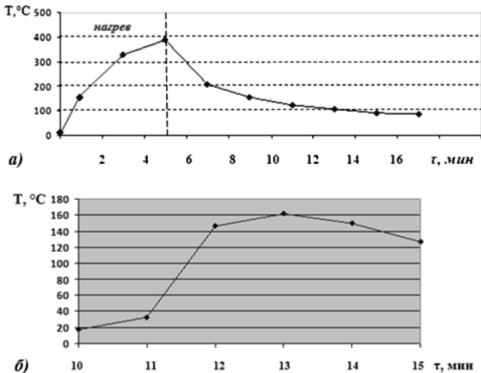
Рисунок 6 – Результаты эксперимента: *a* – изменение температуры на внешней поверхности образца (время воздействия пламени 330 секунд); *b* – изменение температуры на внутренней поверхности образца [Experimental result: *a* – temperature change on the outer surface of the sample (the time of exposure to the flame is 330 seconds), *b* – temperature Change on the inner surface of the sample]
