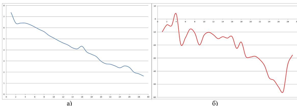
Рисунок 2 – Изменения параметров натурального образца в ходе эксперимента: а) изменение толщины стенки; б) изменение значения РГМН [Changes in the parameters of a full-scale sample during the experiment: a) change in the wall thickness; b) change in the value of the main mechanical stresses]
