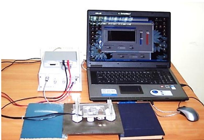
Рисунок 1 – Общий вид системы мониторинга ферромагнитных материалов [General view of the monitoring system of ferromagnetic materials]
