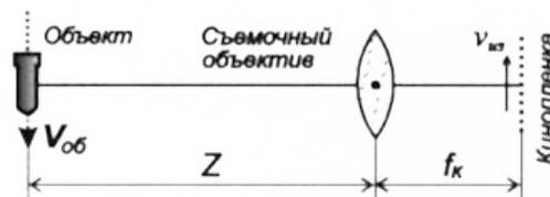
Рисунок 4 – Оптическая схема съемки [Optical design]
