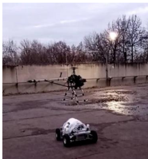
Рисунок 7. Условия проведения эксперимента относительно воздействия акустической нагрузки на показания КГС при измерении спектров \gamma -излучения при естественном шумовом фоне, составляющем 40 дБ и акустическом воздействии 120 дБ [сделано авторами]
