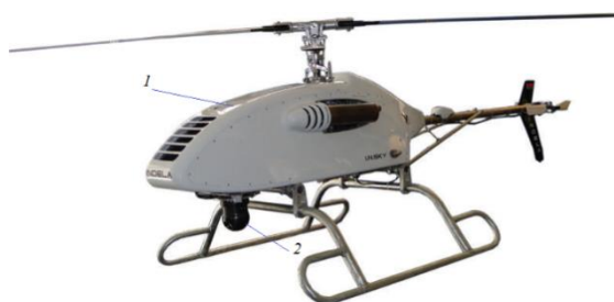
Рисунок 1. БПЛА «INDELA-SKY», КБ ИНДЕЛА (Белоруссия) (1), Система «INDELAOGD-20HIR» (2), состоящая из четырех встроенных модулей (тепловизор, цветная камера, лазерный дальномер, инерциальный модуль), является базовой полезной нагрузкой для БЛА «INDELA-I.N. SKY» при решении традиционных задач разведки, наблюдения и мониторинга [1]
