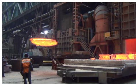
Рисунок 2. Нагрев заготовки тонкостенного днища с подкладным листом в печи ВД-6Т 2
