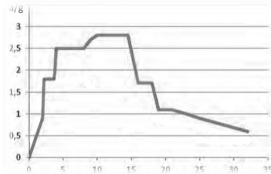
Рисунок 4. Спектр отклика для НВАЭС-2 на отметке +26,30 м a/g – амплитуда колебаний [12] Figure 4. Response spectrum for NVNPP-2 at +26.30 m a/g – oscillation amplitude [12]
