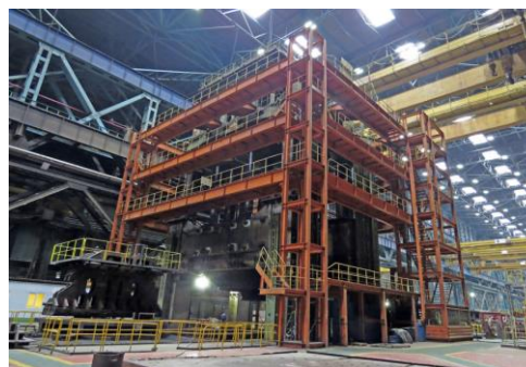
Рисунок 1. Пресс «ИИ» усилием 15000 тонн (Япония), предназначенный для изготовления изделий методом горячей штамповки 1
