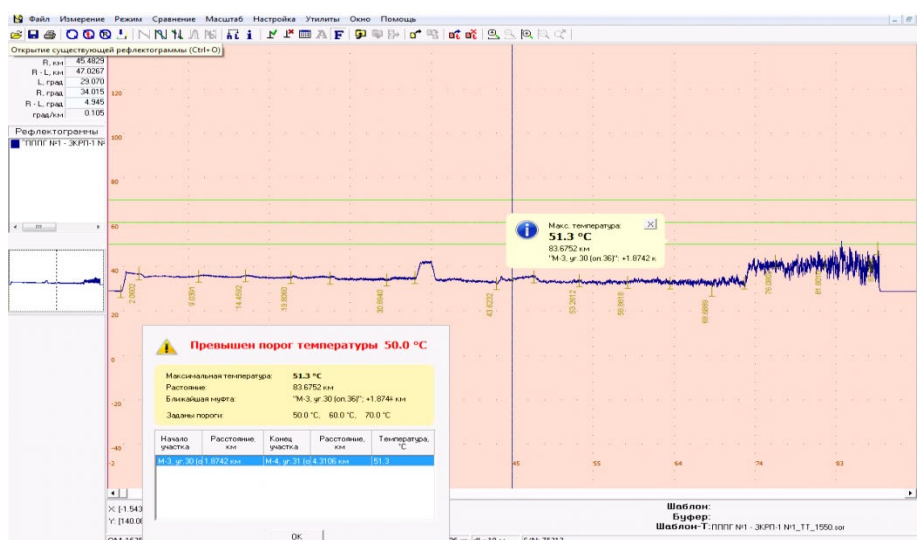
Рисунок 4 – Теплограмма плавки гололеда постоянным током. ВЛ 220 кВ РП 220кВ Волгодонск-Зимовники [Thermogram of smelting ice with direct current. VL 220 kV RP 220kV Volgodonk-Zimovniki]
