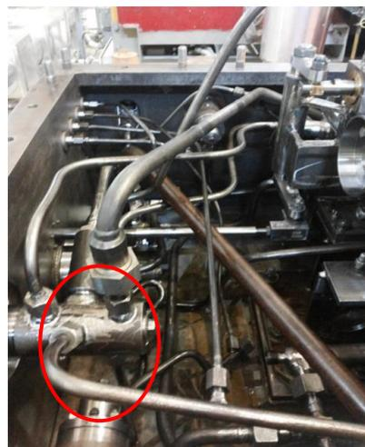
*Рисунок 1. Внутренние элементы блока регулирования турбины К-1200-6,8/50 (обратный клапан перенесен)*
