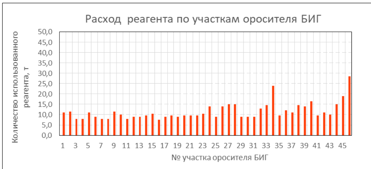
Рисунок 7. Расход реагента для очистки центральной зоны оросителя Figure 7. Reagent consumption for cleaning the central area of the sprinkler
