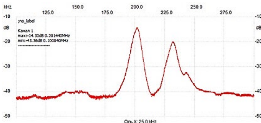
Рисунок 16 – Экспериментальная амплитудно-частотная характеристика (АЧХ) ультразвуковой системы, состоящей из двух передающего и принимающего сигналы ультразвуковых детекторов, максимальное значение которых в области частот (пики) также наблюдаются на частотах 201,44 – 203,75 кГц (данные авторов) [Experimental amplitude-frequency characteristic (AFC) of an ultrasonic system, consisting of two transmitting and receiving signals of ultrasonic detectors, the maximum value of which in the frequency range (peaks) is also observed at frequencies 201.44 - 203.75 kHz (data of the authors)]
