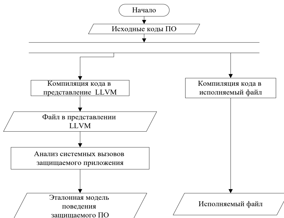
Рисунок 2 – Алгоритм построения модели поведения защищаемого приложения [Algorithm of constructing a behavior model of the protected application]
