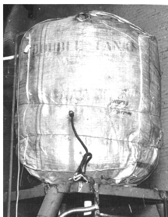
Рисунок 2 – Общий вид расширительного бака с термоизоляцией в системе высокотемпературного охлаждения ДВС [General view of the expansion tank with thermal insulation in the high-temperature cooling system of the internal combustion engine]
