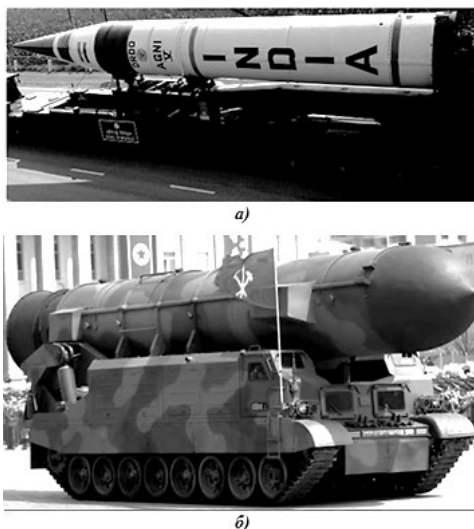
Рисунок 1 – Подвижные пусковые установки с баллистическими ракетами наземного базирования a – без ТПК (Индия); б – с ТПК (КНДР) [Mobile launchers with land-based ballistic missiles a – without transport and launch container (India); b – with transport and launch container (DPR Korea)]
