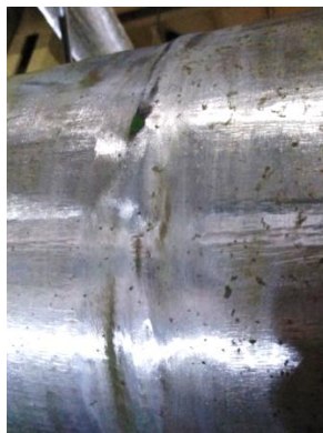
Рисунок 1 – Поверхность сварного соединения СС_1 перед проведением электрофизических измерений [The surface of the welded joint CC_1 before carrying out electrophysical measurements]
